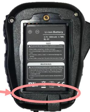
4. バッテリーカバーを下部ほぞ穴に差し込んでから蓋をし、マイナスドライバーで固定ネジを締め込む
