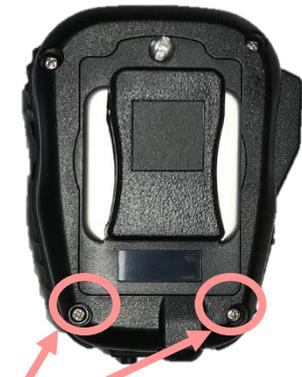
**注：電池本体を持ち上げる際は金属などの工具は電池本体を損傷する恐れがあります。プラスチック等の柔らかいへらをご使用ください。**
