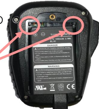
2. バッテリーカバーを外し、電池本体を下部からへら等を使用し持ち上げ取り上げる
